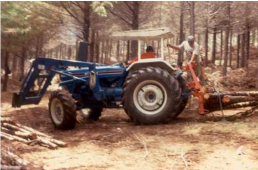
En Costa Rica existen diferentes métodos para realizar el arrastre de madera de plantaciones forestales. Uno de los métodos que presenta más ventajas en nuestro país es el tractor agrícola con un winche acoplado a la toma de fuerza mediante el sistema de tres puntos.
