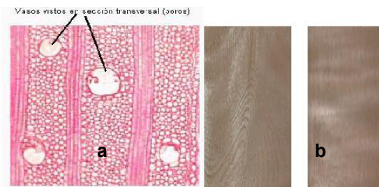
Figura 2. a. Corte transversal de Gmelina arborea mostrando vasos ocluidos con tílides. (Canessa, 2002); b. Cara tangencial y cara radial de tablas de melina.
