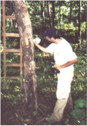
Figura 1. Demostración de la medición de las tensiones de crecimiento con un extensómetro a 1,3 m de altura. Guanacaste, Costa Rica, 2001.
