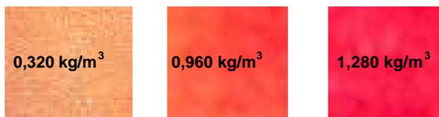
**Figura 2.** Retención ABE (p/v) según coloración en la madera de melina con sustancia reveladora de boro (ABE = Equivalencia de Ácido Bórico).
