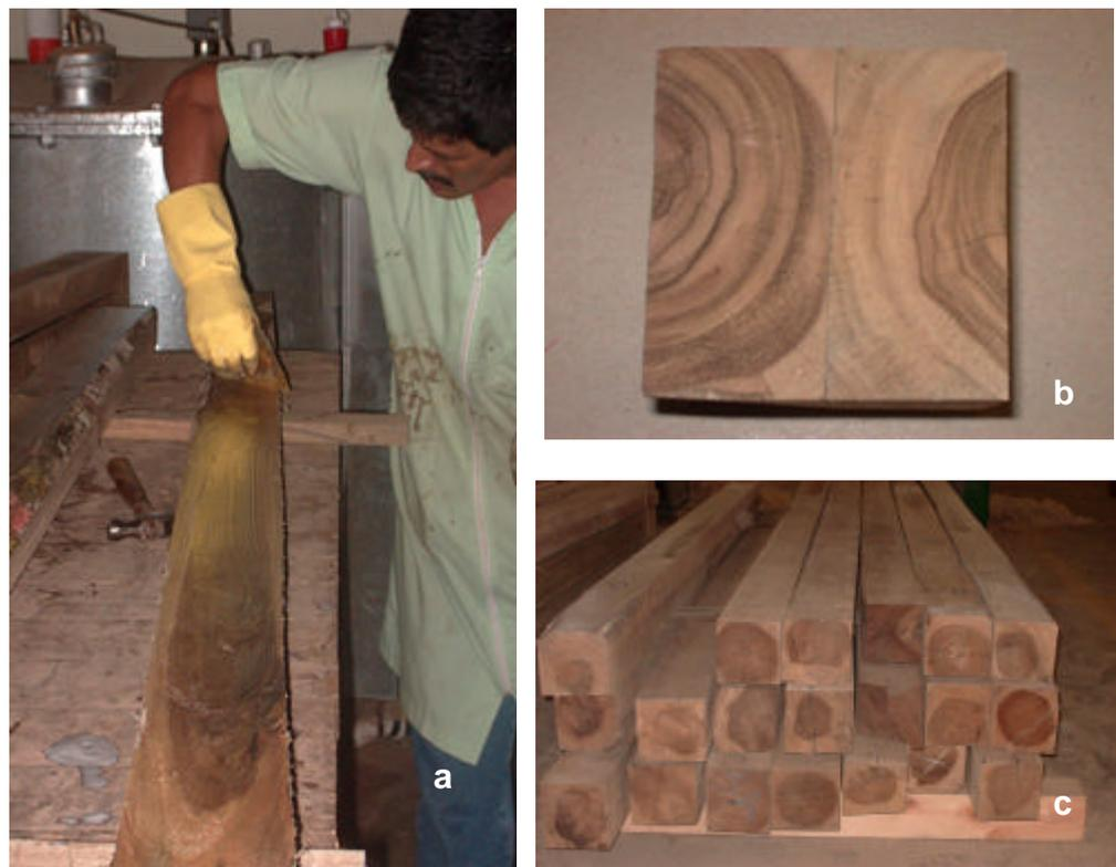
**Figura 3.** Aplicación de adhesivo (a), vista transversal de viga encolada (b) y vigas sólidas de control (c). Instituto Tecnológico de Costa Rica.
