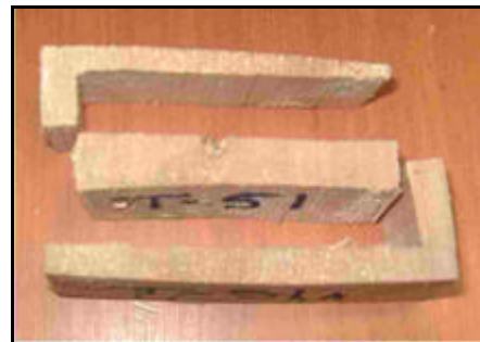
Figura 3. Probetas para el control de uniformidad del contenido de humedad.
