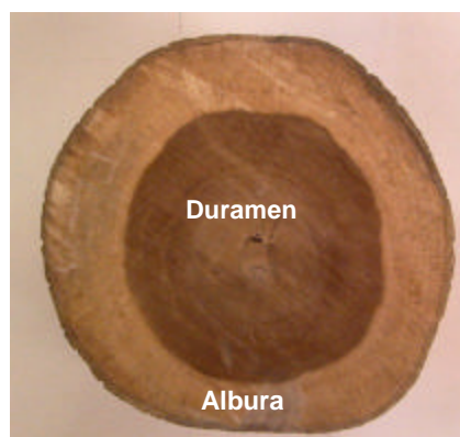
Diferenciación de albura (parte clara) y duramen (parte oscura) en Cordia alliodora .
