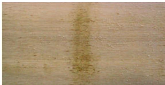
**Marcas de bolillos, cuchillas y máquinas:** algunas veces en la superficie de madera cepillada o sin cepillar, aparecen marcas producidas por bolillos, ganchos o cuchillas utilizadas para la movilización y el labrado de las piezas de madera. Esta pieza de melina muestra una marca producida por un bolillo de alimentación en una cepilladora durante el proceso de su elaboración.
