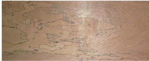
**Mancha de mohos:** las manchas producidas por este tipo de hongos, se limitan a la superficie de la madera, y pueden ser eliminadas, limpiando la superficie con un trapo húmedo, o durante el cepillado de las tablas. Sin embargo, su presencia indica que la madera se encuentra en condiciones propicias para el desarrollo de otros tipos de hongos, como los cromógenos y los xilófagos.
