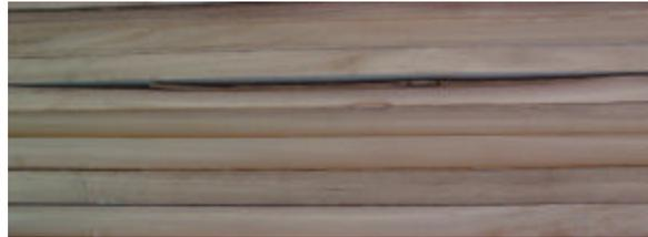
**Fallas de compresión:** las rayitas finas, transversales, irregulares y tenues, que se observan en la parte superior de esta pieza de melina, son fallas de compresión perpendicular a la longitud de las fibras, que se originan como consecuencia de los esfuerzos de compresión longitudinal en árboles en pie. Las fibras se presentan partidas, constituyéndose en una parte de la pieza de madera de resistencia mecánica muy débil y peligrosa en madera estructural.
