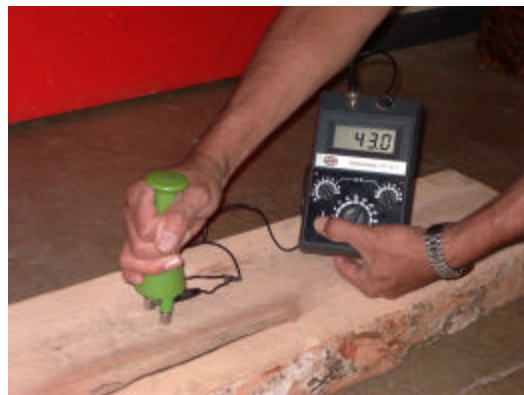
Determinación de contenido de humedad por métodos eléctricos.
