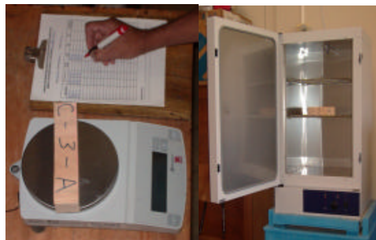
Determinación de contenido de humedad por método gravimétrico.
