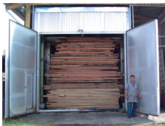
Secado artificial de madera en hornos
