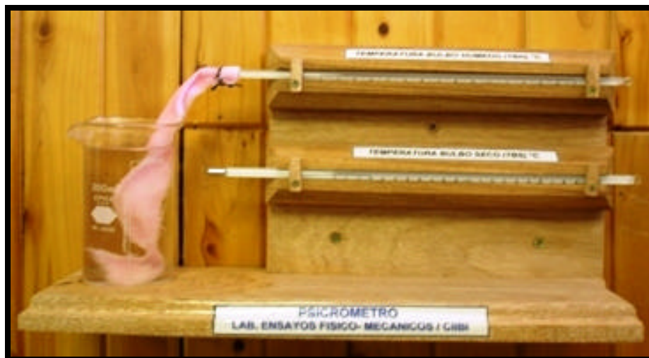
Figura2. Psicrómetro, mide las temperaturas de bulbo húmedo y bulbo seco (Laboratorio de propiedades físico-mecánicas de la madera CIIBI)
