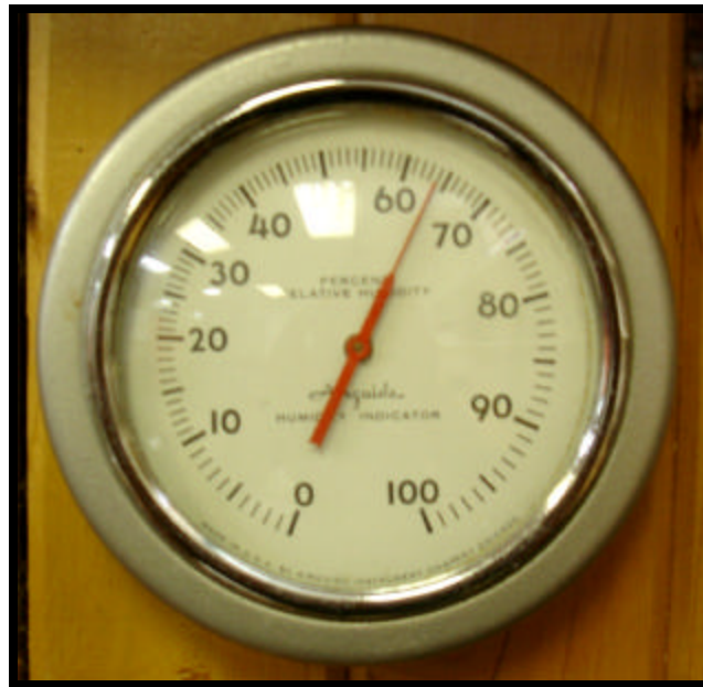
Figura 1. Higrómetro (con lámina de celulosa), mide en porcentaje la HR (Laboratorio de propiedades físico-mecánicas de la madera CIIBI)
