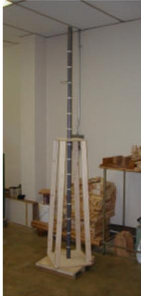
**Figura 2.** Equipo del CIIBI-ITCR utilizado para los ensayos de resistencia al impacto para pisos.
