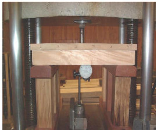
**Figura 5.** Equipo de laboratorio especial para medir la respuesta del piso a cargas pesadas y concentradas.
