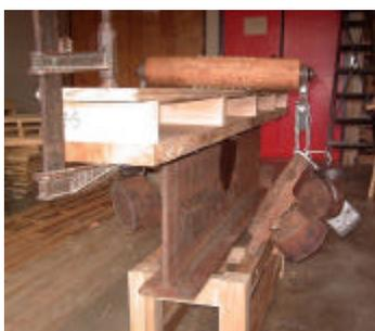
**Figura 7.** Equipo del CIIBI-ITCR para la determinación de la resistencia de los pisos a la perforación de cargas concentradas en superficies pequeñas.
