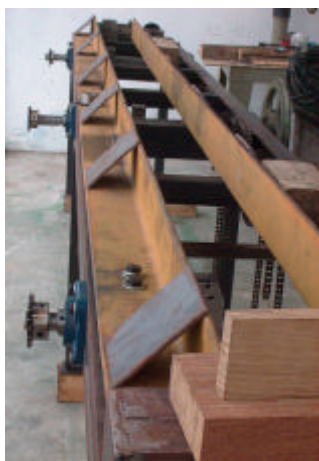
Figura 5. Diseño de prensa mecánica para las uniones dedo (finger joint) de alas y almas y el ensamblado final.
