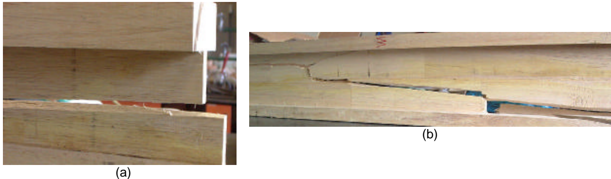
Figura 6. Principales fallas de las vigas en el ensayo de flexión. Madera de Terminalia amazonia .
