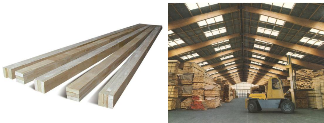
Figura 1. Vigas laminadas con madera de melina ( Gmelina arborea (Roxb)) y posibles usos en bodegas de grandes dimensiones.
