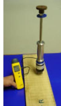
**Figura 5.** Medición del contenido de humedad utilizando un medidor eléctrico.
