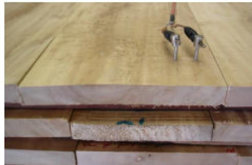
**Figura 7.** Colocación de la sondas de control de contenido de humedad. Observe que la tabla presenta madera radial y tangencial, la sonda fue colocada en la parte de madera radial.
