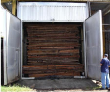
**Figura 1.** Secado convencional al horno, frecuentemente utilizado en el secado de la madera de melina.
