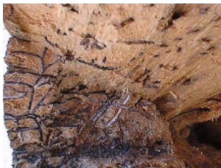
Daño en pieza de madera causado por escarabajos de ambrosía (Fotografía: Edwin Canessa)
