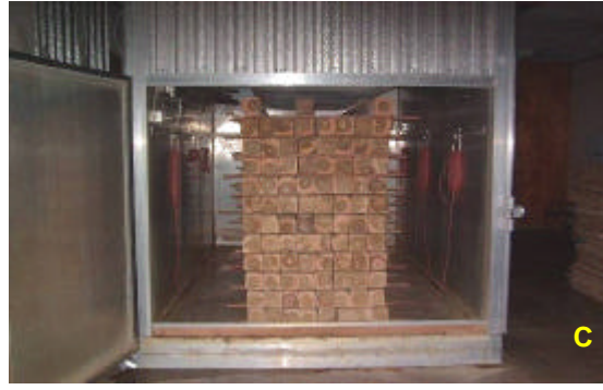
Secadores tipo convencional. A. solar capacidad 6 m 3 . B. NARDI ® , capacidad 20 m 3 . (Cortesía R. Córdoba, 2005). C. NARDI ® , capacidad 2 m 3 . Instituto Tecnológico de Costa Rica.
