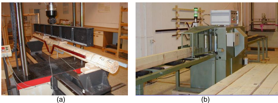
Figura 5. Máquina universal de ensayos (a) y clasificadora mecánica automática Cook-Bolinder de la casa SG-AF Techmac (b).
