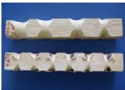
Superficies torneadas con gubia ingresando en forma inclinada y en forma horizontal
