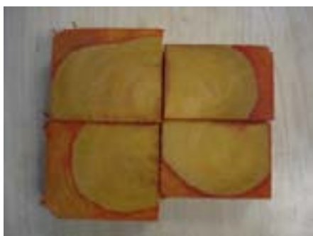
Penetración de sales de boro a los 5 días de iniciada la difusión, limitándose a la albura (el color rojo indica la penetración del preservante)
