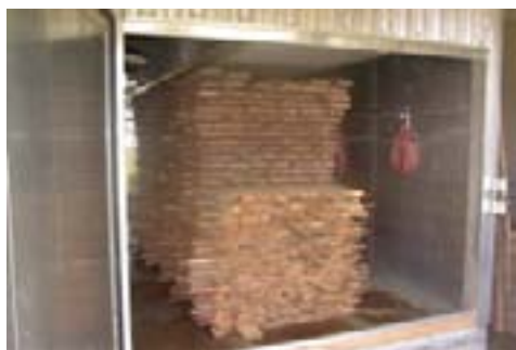
Secado en cámara convencional
