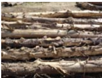
Alta incidencia de nudos que afectan el proceso de aserrío
