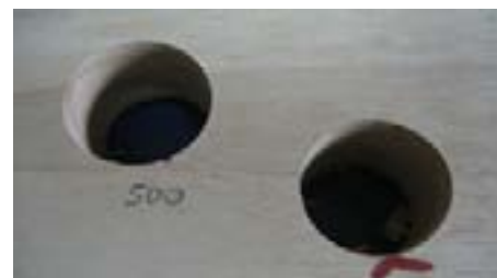
Orificios taladrados de excelente calidad obtenidos con broca para madera
