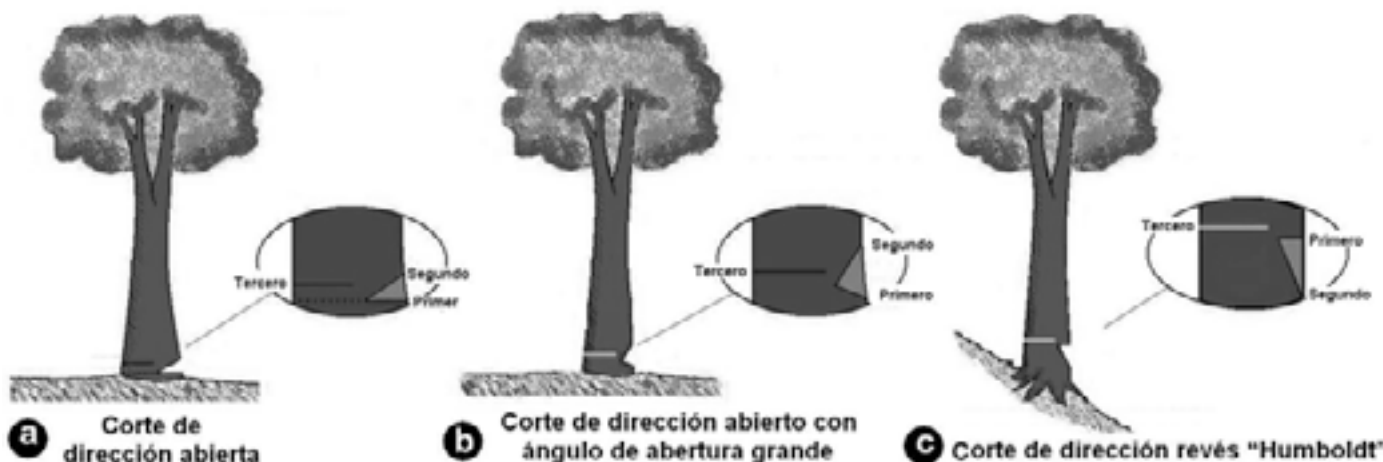
Figura 2. Tipos de corte utilizados en la operación de corta de árboles en plantaciones forestales.
