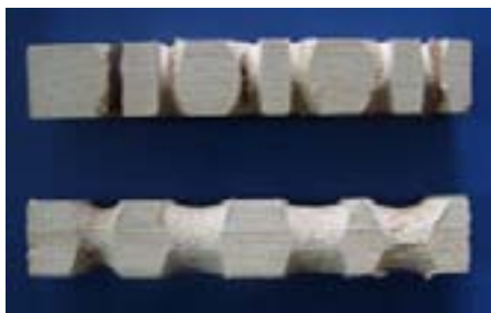
Superficies torneadas con gubia ingresando en forma inclinada y horizontal
