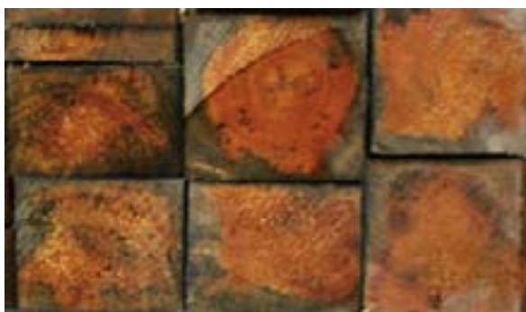
Piezas de madera aserrada preservadas a presión
