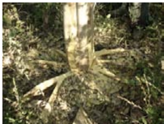
Eliminación de “aletones” antes del corte del árbol
