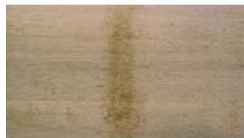
Mancha de separador por tiempo prolongado de secado
