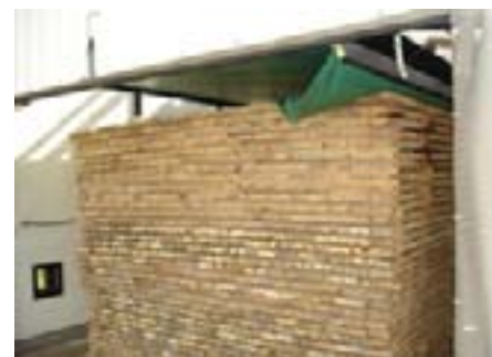
Apilado en cámara de secadora solar
