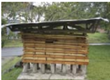
Apilado y protección de la madera durante el secado solar
