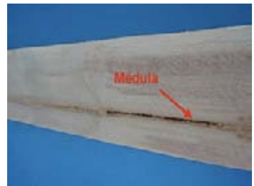
Presencia de la medula en la madera aserrada
