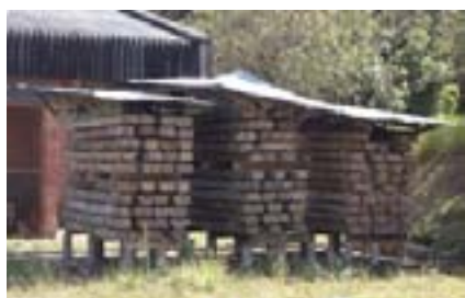
Secado al aire de bloques de 7,5 cm de espesor
