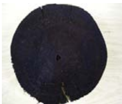
Poste preservado a presión (el color azul es indicador de la penetración del preservante)
