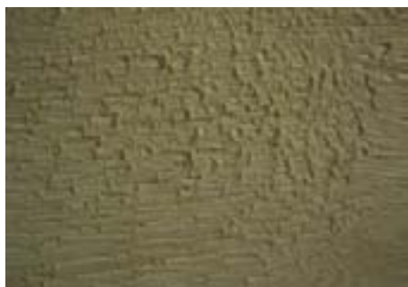
Superficie con grano arrancado moderado y con vellosidades
