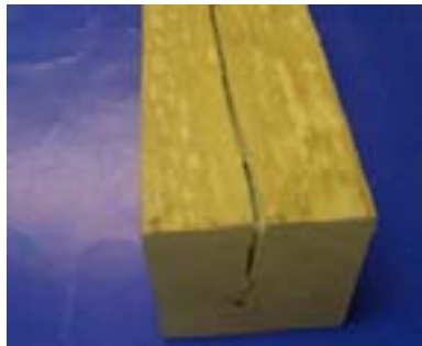
Rajaduras longitudinales por cabeza luego del secado (asociada con presencia de médula)
