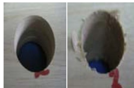
Calidad de orificios obtenidos con broca para madera y broca para metal
