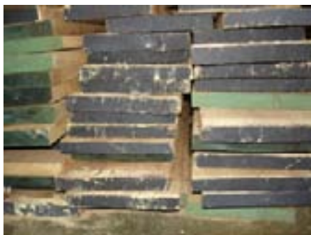
Calidad de madera seca al horno con poca presencia de rajaduras y torceduras
