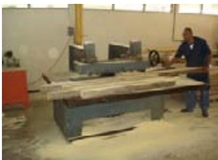
Proceso de reaserrío en plantas estacionarias
