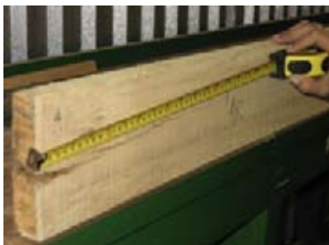
Rajaduras longitudinales luego del secado
