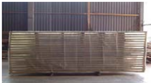
Apilado de madera preservada con boro (cubierta para evitar circulación de aire en la difusión del preservante)
