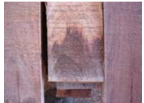
Decoloración en los extremos de las tablas por secado de las trozas en esa parte
