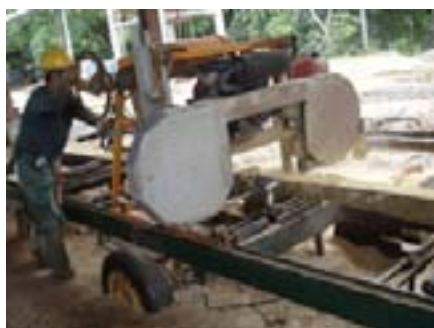
Aserrío de diámetros menores con sierra de cinta horizontal
