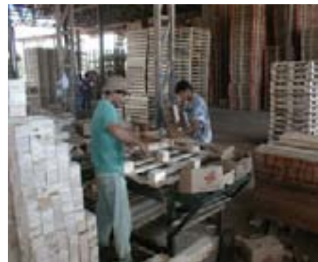
Operación de clavado en tablas durante la fabricación de tarimas
