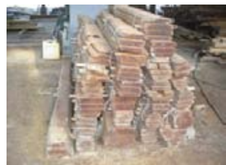
Madera aserrada por lo ancho de troza
