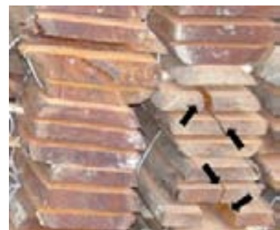
Presencia de rajaduras en tablas de caoba luego del secado
