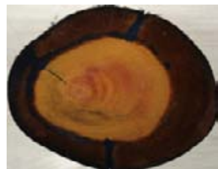
Penetración nula en el duramen e irregular en la albura limitándose en las zonas de las grietas (el color azul indica la penetración del preservante)
