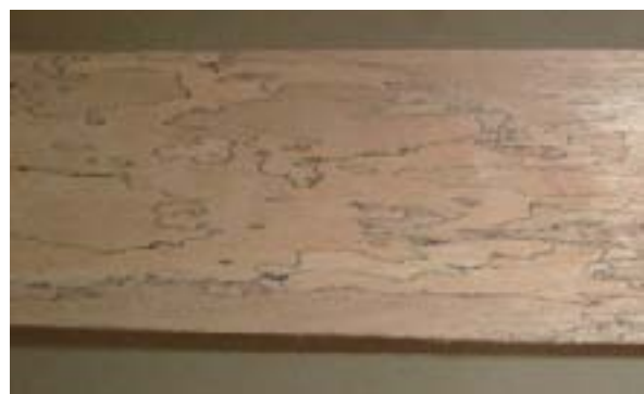
Madera que ha estado por mucho tiempo en contacto con el suelo, afectada por hongos de pudrición
