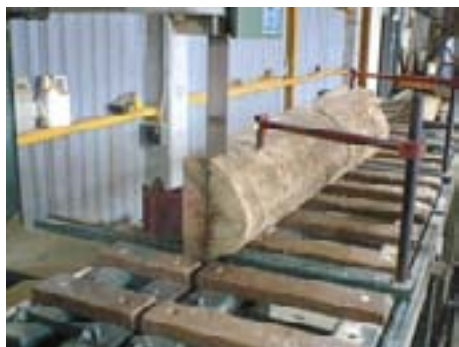
Aserrío de trozas de pequeño diámetro con sierra de cinta
