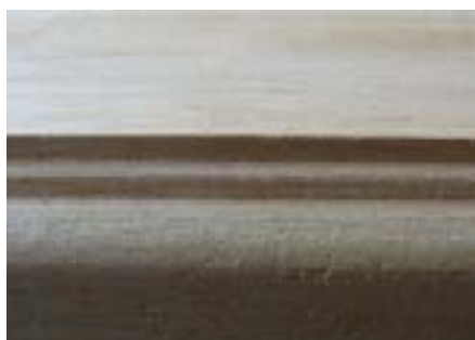
Superficie moldurada de buena calidad
