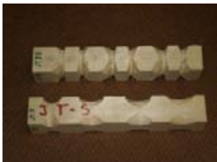
Presencia de astillado y grano arrancado en torneado
