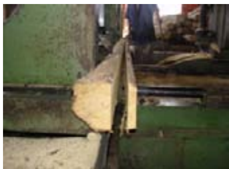
Presencia de tensiones de crecimiento durante el aserrío con aserradero tradicional
