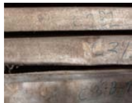
Hongos de manchas en madera seca al aire que no se cubrió apropiadamente durante el secado
