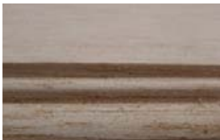
Superficie moldurada, de buena calidad
