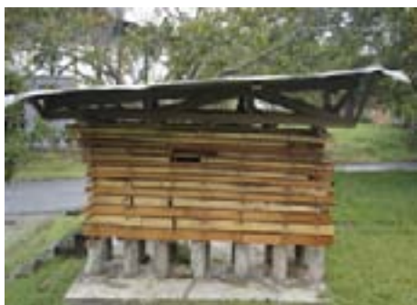
Pila de secado al aire (madera de cebo en combinación con madera de caoba)
