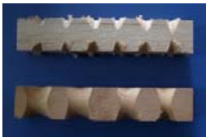
Superficies obtenidas torneadas con gubia ingresando en forma inclinada y horizontal
