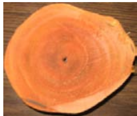
Poste preservado a presión. No muestra la penetración del preservante.
