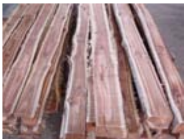
Madera en condición verde antes del secado
