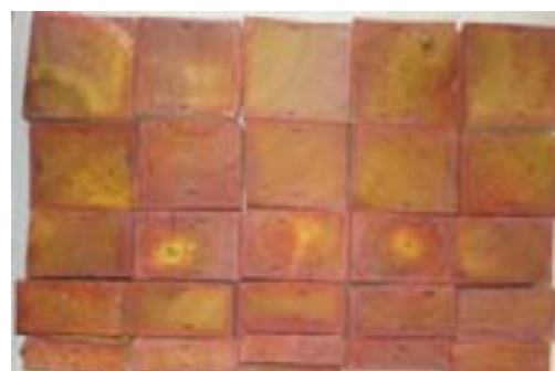
Penetración de las sales de boro con 5 días de almacenamiento (el color rojo indica la penetración del preservante)
