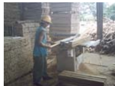
Recuperación de costillas con sierra circular en un aserradero
