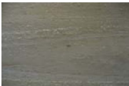
Presencia de grano vellosa leve en las superficies lijadas
