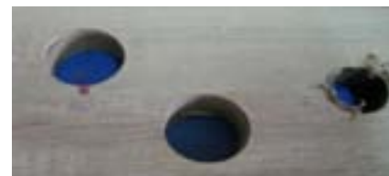
Calidad de los orificios obtenidos en el taladrado con broca de madera
