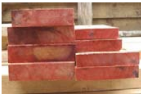
Color rojo intenso indica penetración casi total del preservante
