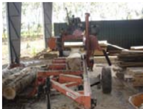
Aserrío con aserraderos portátiles en trozas con 30 a 40 cm de diámetro
