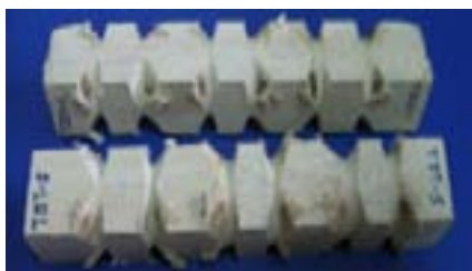
Superficies obtenidas torneadas con gubia ingresando en forma inclinada
