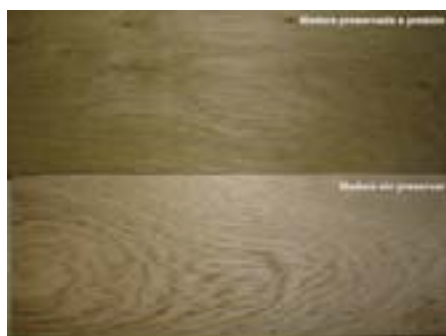
Aspecto de la madera preservada con tratamiento de sales de cobre
