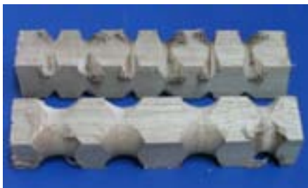
Calidad de la superficies generada durante el torneado
