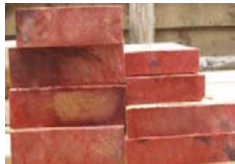
Penetración de las sales de boro con 28 días de almacenamiento (el color rojo indica la penetración del preservante)
