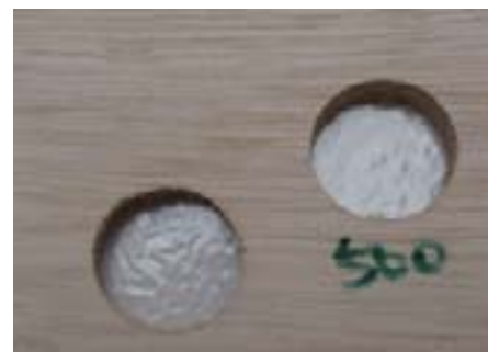
Orificios de buena calidad, taladrados con broca para madera
