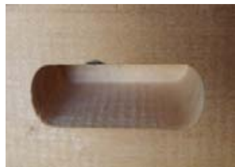
Orificio escopleado de excelente calidad
