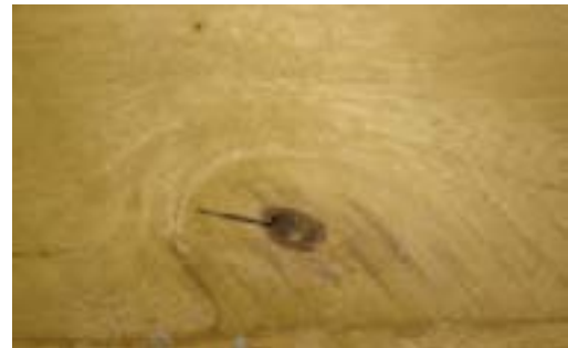
Grietas luego del secado (asociado con presencia de nudos)
