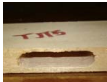
Caja de muy buena calidad para el escopleado
