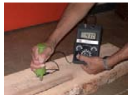
Medición del contenido de humedad con métodos eléctricos, luego del secado
