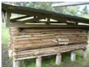
Muestras de control de humedad en una pila de secado al aire
