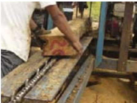
Aserrío de trozas en sierra doble de cadenas
