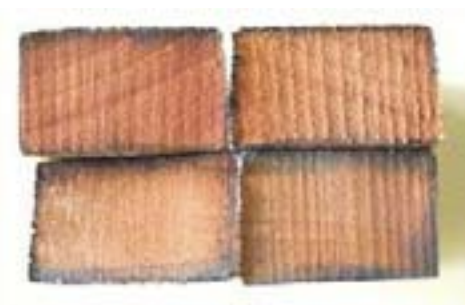
Penetración casi nula en madera con duramen (el color azul indica la penetración del preservante)
