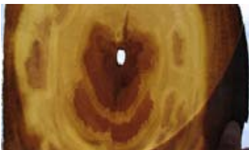
Presencia de "ultrahumedad" por ataque de bacterias en el árbol en pie y con posibles problemas de secado
