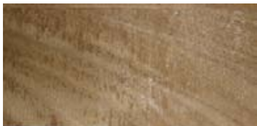
Presencia de grano arrancado luego del cepillado
