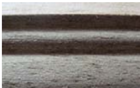
Superficie moldurada de muy buena calidad en pochote
