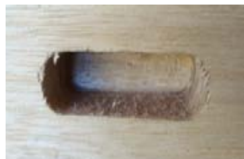
Orificio escopleado con presencia de vellos en la superficie
