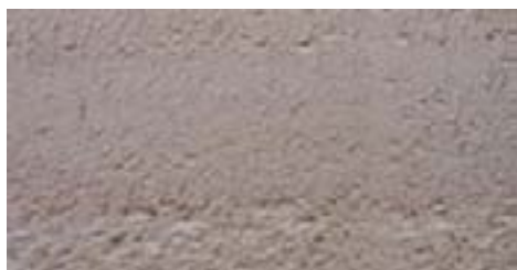
Presencia de grano arrancado luego del cepillado, muy común en jaúl
