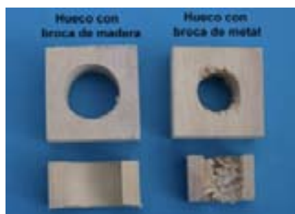
Calidad de taladrado en melina con brocas para madera y para metal
