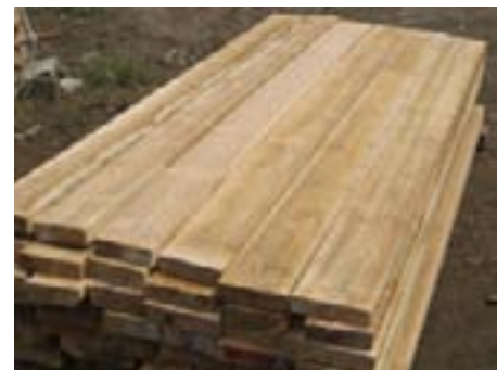
Madera de pochote de 3,81 cm de espesor, una vez finalizado el proceso de secado al aire
