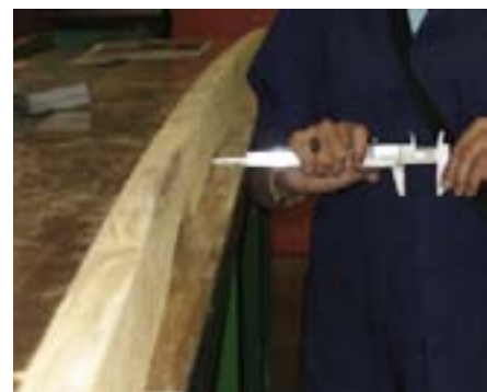
Arqueadura en madera aserrada luego del secado
