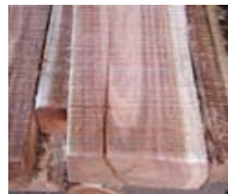
Reventaduras en madera luego del secado al aire
