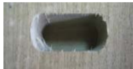
Orificio escopleado con presencia de vellos en la superficie
