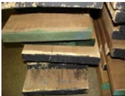
Presencia de rajaduras longitudinales asociado a la médula, luego del secado
