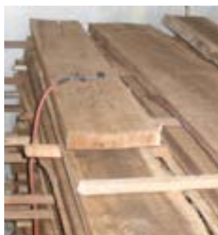
Localización de las sondas de control de humedad en la madera
