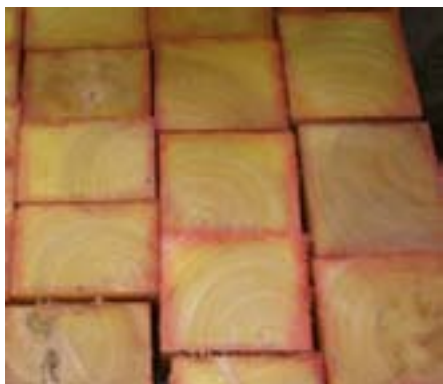
Penetración de sales de boro con 50 días de almacenamiento (el color rojo indica la penetración del preservante).
