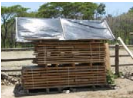
Pila de secado al aire cubierta con techo de plástico
