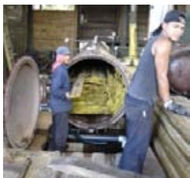
Preservación vacío – presión
