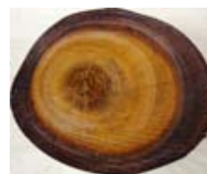
Penetración nula en madera de duramen, el color azul indica la penetración del preservante
