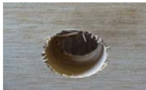
Orificios taladrados con broca para madera de buena calidad
