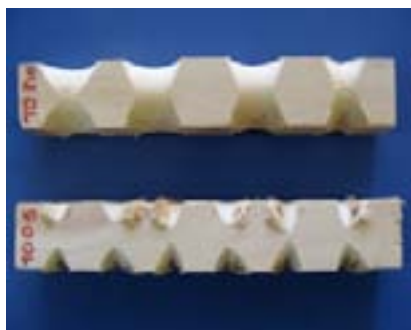
Superficies torneadas con gubia ingresando en forma inclinada y horizontal
