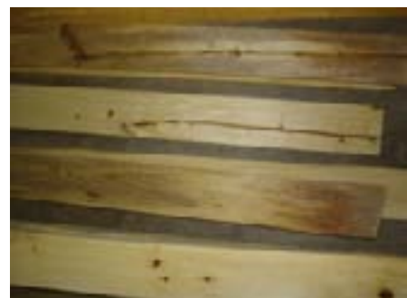
Madera aserrada, mostrando los nudos y la presencia de la médula
