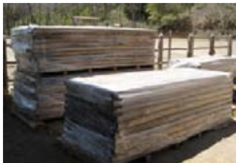
Madera cubierta con plástico durante el período de almacenamiento en la preservación con sales de boro
