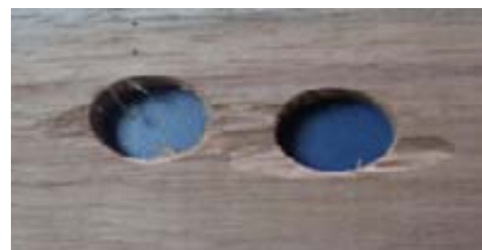
Superficie rasgada a la salida de la broca para madera, pero los orificios taladrados son de excelente calidad
