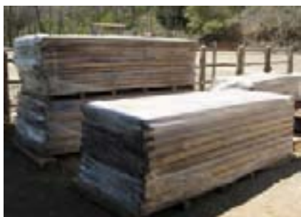
Madera preservada con boro (cubierta para difundir el preservante)
