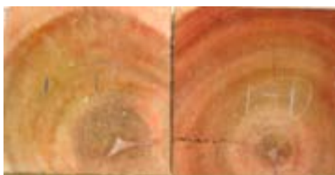
Madera preservada con boro, la poca tonalidad de rojo indica la penetración y baja retención del preservante
