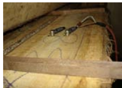
Ubicación de las sondas de medición de humedad en la madera
