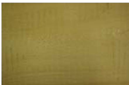
Superficie con grano arrancado moderado y leve presencia de marcas de cuchillas
