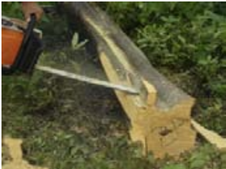
Eliminación de los "aletones" para mejorar la forma de la troza
