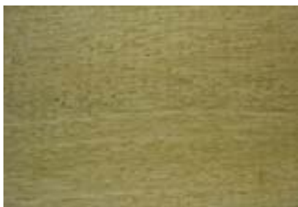
Superficie con grano arrancado moderado
