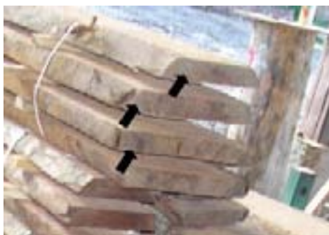
Presencia de acanalado en madera aserrada de caoba luego del secado
