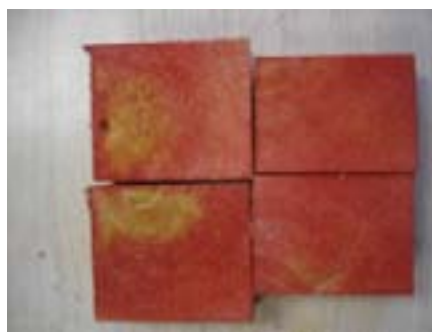
Penetración de sales de boro a los 120 días de iniciada la difusión, limitándose a la albura (el color rojo indica la penetración del preservante)
