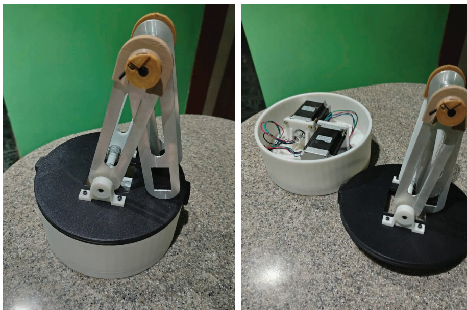
Figura 4. Implementación del ensamble del robot. Base giratoria cerrada y base giratoria abierta. (Fuente: elaboración propia)
