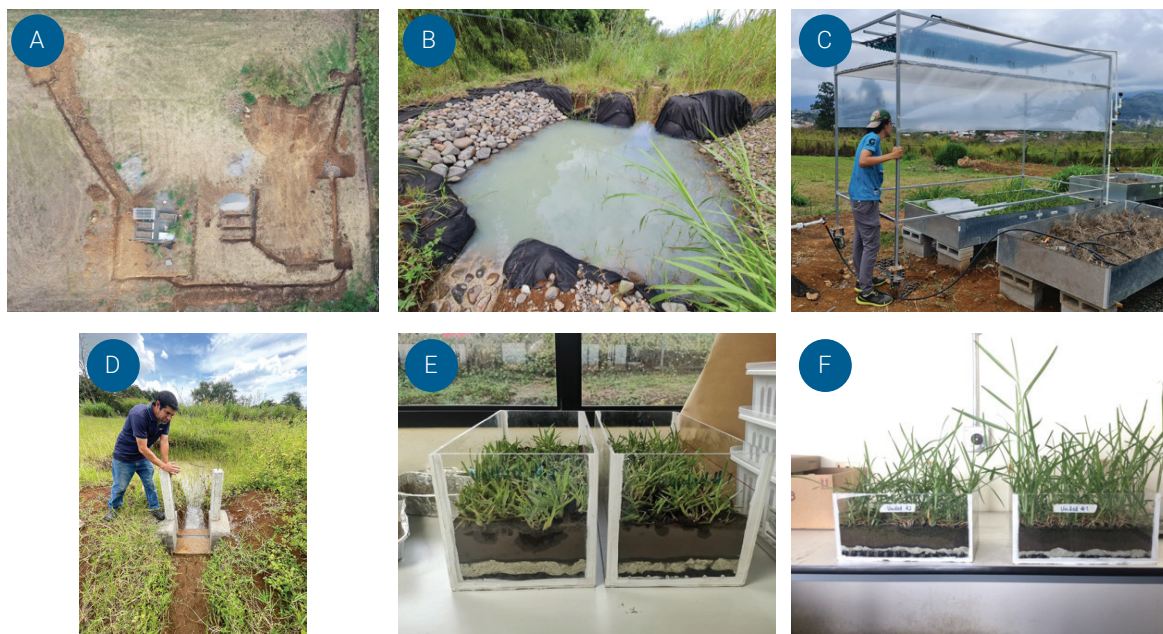
Figura 2. Estructuras implementadas en el Laboratorio de Adaptación al Cambio Climático basado en Infraestructura Verde (LACCLIVE), donde a) vista aérea del sitio en construcción, b) laguna de detención con vertedero, c) techos verdes y simulador de lluvia, d) instalación de compuerta, e) techos verdes a escala para evaluar contaminantes, f) franjas verdes a escala para evaluar contaminantes (Elaboración propia).
