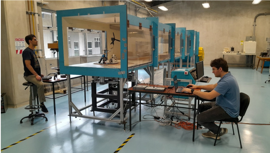
Figura 14. Toma de datos de empuje en el túnel de viento.
