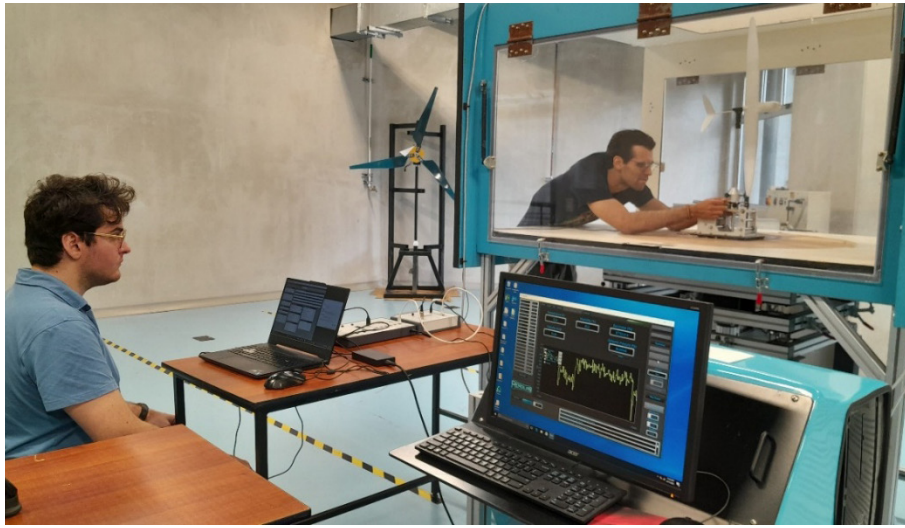
Figura 9. Ajuste de la balanza durante el experimento
