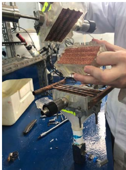
Fig. 3. Vista del Intercambiador de calor compacto fabricado mediante impresión 3D: se aprecian los tres tubos de cobre para la circulación del agua caliente y las dos mitades de esponjas de cobre que se unen a estos. [5]
