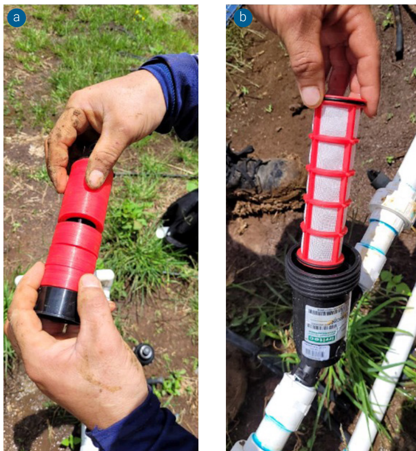
Figura 3. Filtro de anillos (a) y filtro de malla (b) utilizados en las pruebas.
