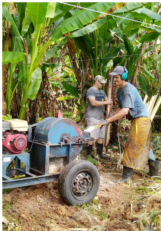
Figura 2. Máquina tipo "deco" con motor de gasolina que procesa las "cáscaras" del pseudotallo y separa las fibras.
