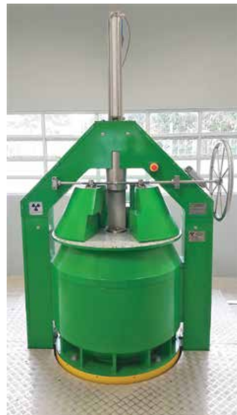
Figura 3. Equipo de irradiación gamma-cell del Laboratorio de Irradiación Gamma del Tecnológico de Costa Rica.
