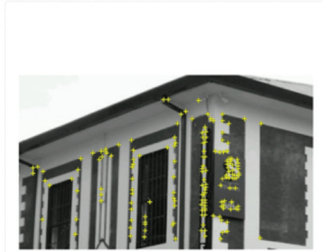
Figura 3. Imagen procesada con Vuforia que muestra los marcadores generados. Como puede observarse en este caso, el signo en la fotografía tiene muchas irregularidades, lo cual denota un grado de “aumentabilidad” con calificación 4 estrellas de 5.
