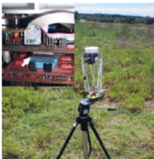
Figura 2. Un prototipo de nodo de localización sonora, en la pampa argentina. Nótese en el detalle el circuito localizador construido. Tecnología CMOS de 0,35 micrones.
