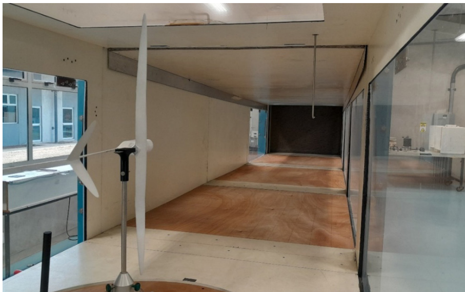
Figura 8. Montaje del modelo dentro del túnel de viento en el Laboratorio de Transferencia de Calor de la Escuela de Ingeniería Mecánica de la Universidad de Costa Rica.
