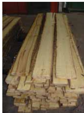
Aserrío de trozas de amarrillón ( Terminalia amazonia ) para la obtención de madera aserrada para uso estructural con valores de diseño.
