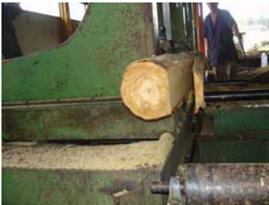
Aserrío de trozas de amarrillón ( Terminalia amazonia ) para la obtención de madera aserrada para uso estructural con valores de diseño.
