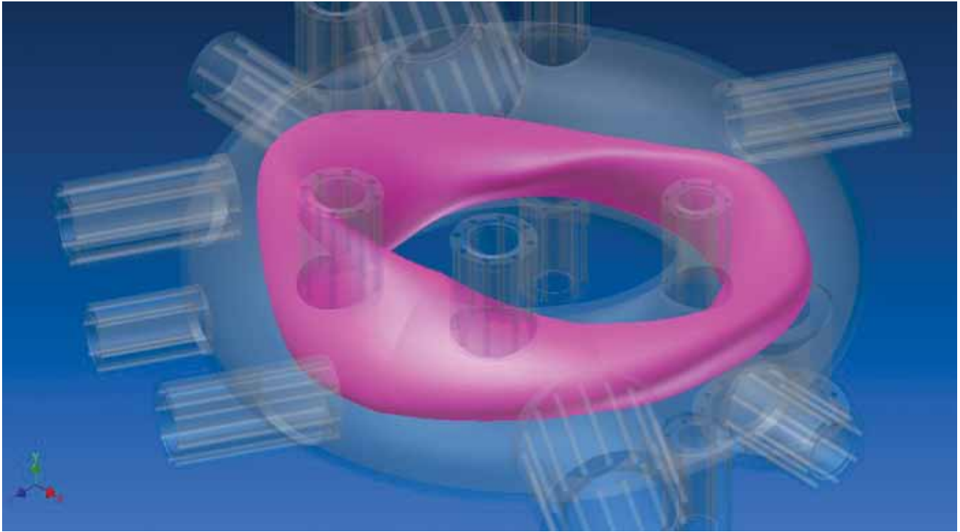
Forma del plasma (color rosado) dentro del Stellarator de Costa Rica 1 (SCR-1).
