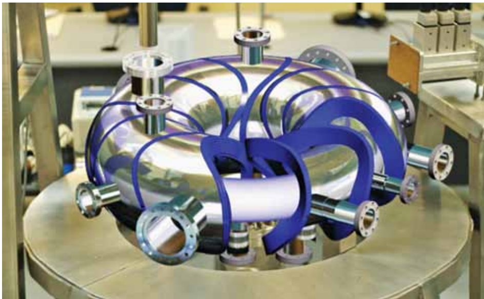
Stellarator de Costa Rica 1 (SCR-1) en construcción en el TEC. La cámara para condiciones de vacío está siendo fabricada en el Instituto Costarricense de Electricidad (ICE).
