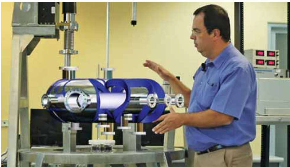
Imagen computarizada del Stellarator de Costa Rica 1 (SCR-1), en construcción en el TEC. El investigador Iván Vargas muestra el funcionamiento.
