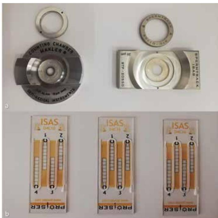
**Figura 4:** Cámaras de recuento espermático reutilizables (a) y desechables (b) con diferentes profundidades entre porta y cubreobjetos. El principio de llenado de la muestra varía según el tipo de cámara de recuento, por dispersión de la gota (a) o capilaridad (b).
