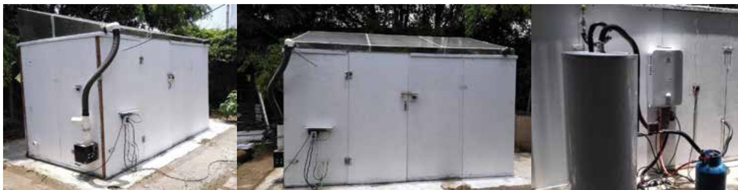
Figura 2. Prototipo de sistema térmico solar híbrido forzado desarrollado por el Grupo de investigación en sistemas térmicos solares para la agricultura, Instituto Tecnológico de Costa Rica, Campus Tecnológico Local San Carlos.
