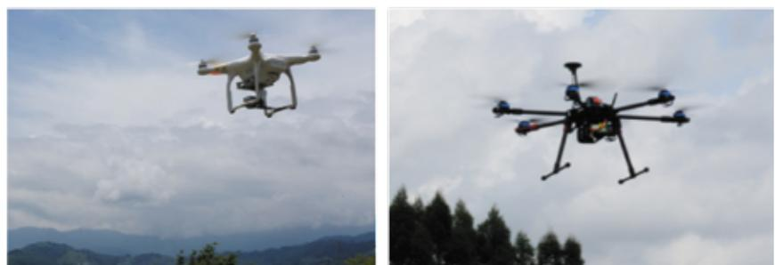
Figura 3. Ejemplos de plataformas multirrotores utilizadas en el Laboratorio de Fotogrametría del TEC: (a) sistema comercial DJI Phantom 3 Professional; (b) plataforma abierta basada en el controlador PixHawk 2.
