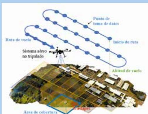
Figura 1. Esquema conceptual sobre el procedimiento para realizar un levantamiento fotogramétrico terrestre: El vehículo aéreo se programa para seguir una trayectoria autónoma, durante la cual toma datos e imágenes de toda la superficie bajo estudio con suficiente redundancia (traslape) para su posterior procesamiento.
