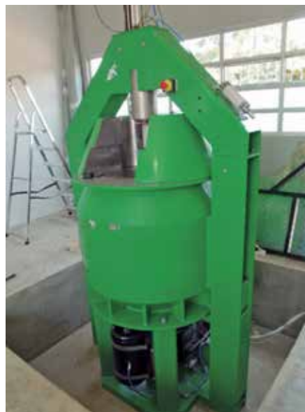
El gammacell pesa 10 toneladas debido a su blindaje de plomo, que permite garantizar la seguridad radiológica.
