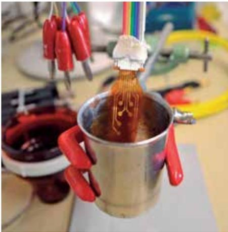
Figura 5. Medición de la transferencia de carga entre el electrodo y la disolución.
