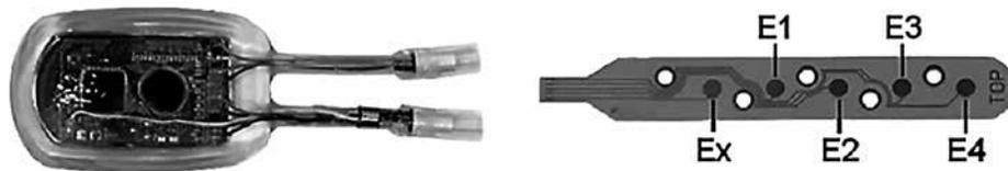
Figura 3. Implante invasivo para la toma de señales biológicas, desarrollado por Lait Abu-Saleh en el laboratorio de nanoelectrónica de la TUHH.
