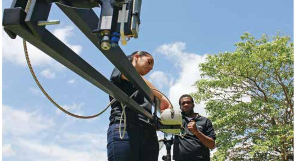
Toma de firmas espectrales en pastos realizada con un espectrorradiómetro que captura reflectancia de la cobertura en un rango de longitud de onda de 325 a 1075 nanómetros. Los investigadores del PRIAS, Lloyd Foster Burr y Heileen Aguilar Arias, realizan la calibración inicial del instrumento. Fotografía de Andrés Barahona Contreras.
