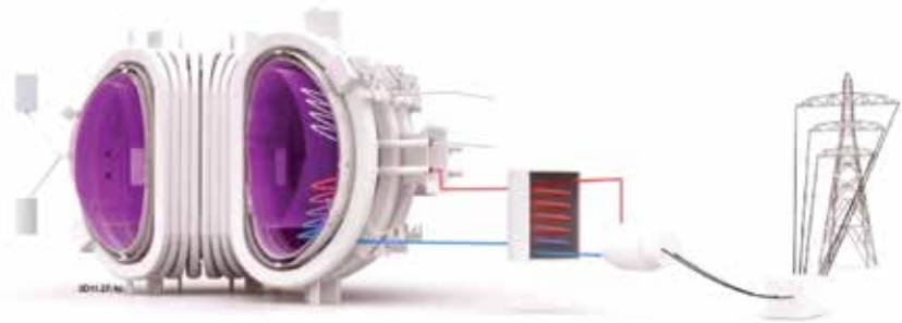
Figura 4. Esquema simplificado de la producción de electricidad mediante un tokamak . Imagen de JET EFDA.
