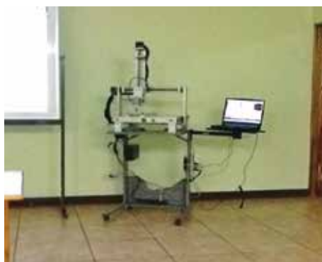
Figura 1. Máquina CNC modeladora para elaboración de productos a utilizarse en el área de la arquitectura y la ingeniería.
