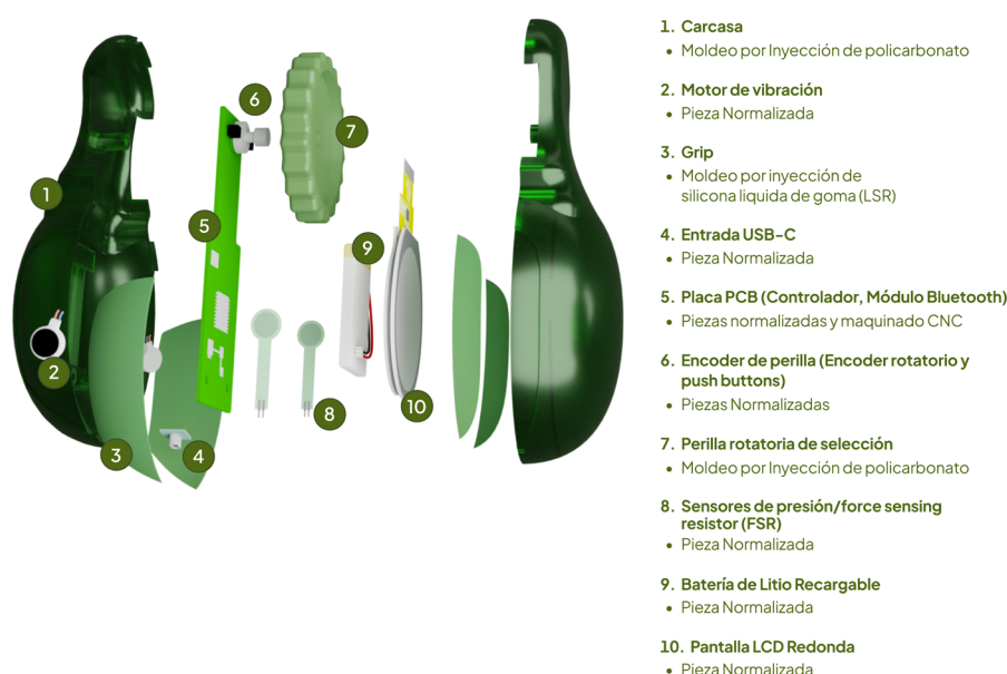
Fig. 5. Componentes, materiales y procesos de fabricación.
