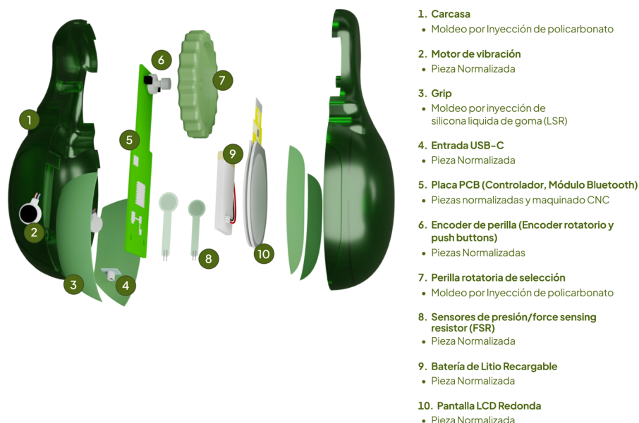
Fig. 5. Componentes, materiales y procesos de fabricación.
