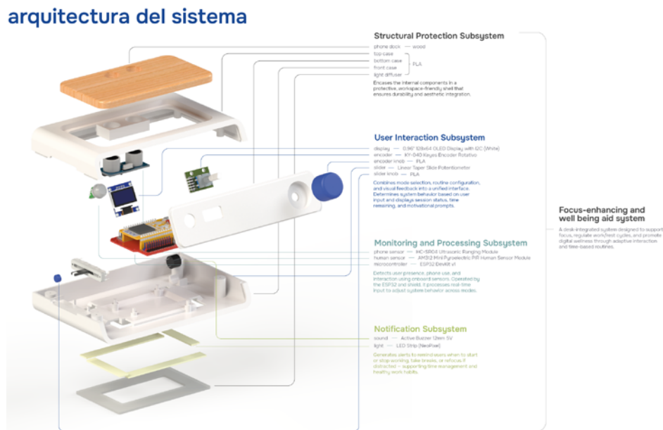
Fig. 4. Esquema de sistema y subsistemas de Mindu.
