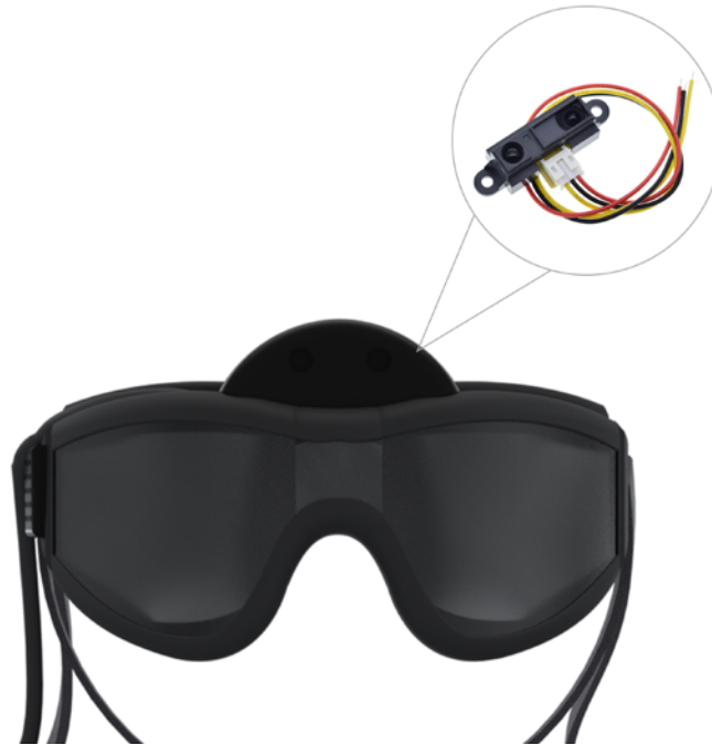
Fig. 3. Domo con sensor infrarrojo Sharp.
