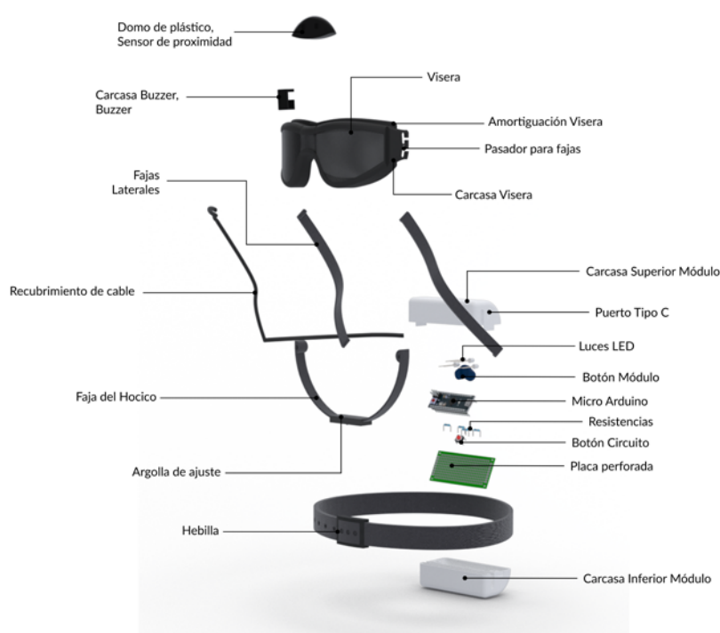
Fig. 2. Gafas inteligentes para perros con discapacidad visual
