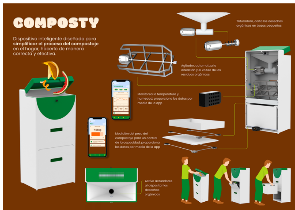
Fig. 2. Lámina explicativa sobre funcionamiento, partes y componentes.
