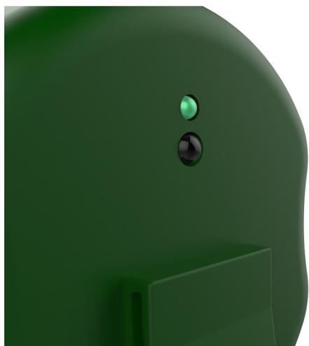
Fig. 5. Puntero láser y cámara integrada.
