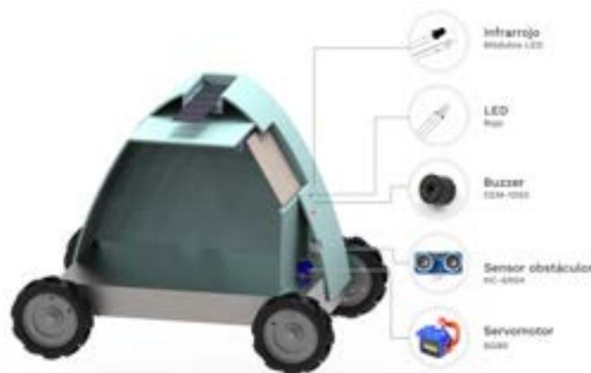
Fig. 7. Componentes delanteros.
