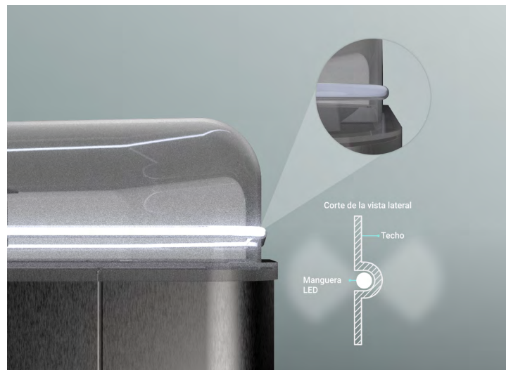
Figura 6. Iluminación de los cubículos
