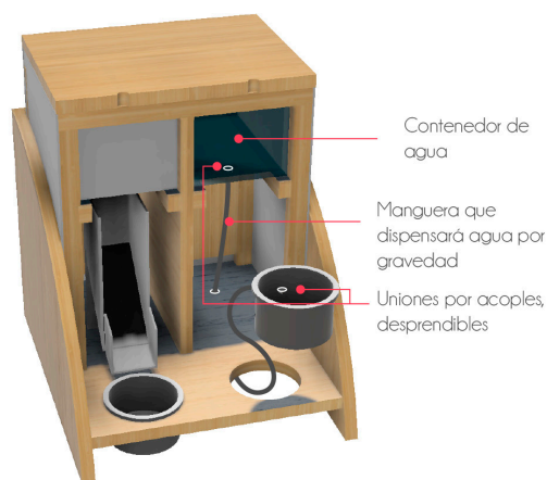
Figura 6. Detalle del sistema dispensador de agua. Fuente: Elaboración propia (2018).
