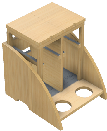
Figura 2. Piezas de plywood que se maquinan manualmente. Fuente: Elaboración propia (2018).
